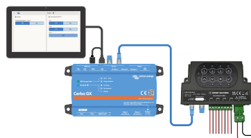
SmartSwitch DC4 ansluten sist i VE.Can-nätverket
