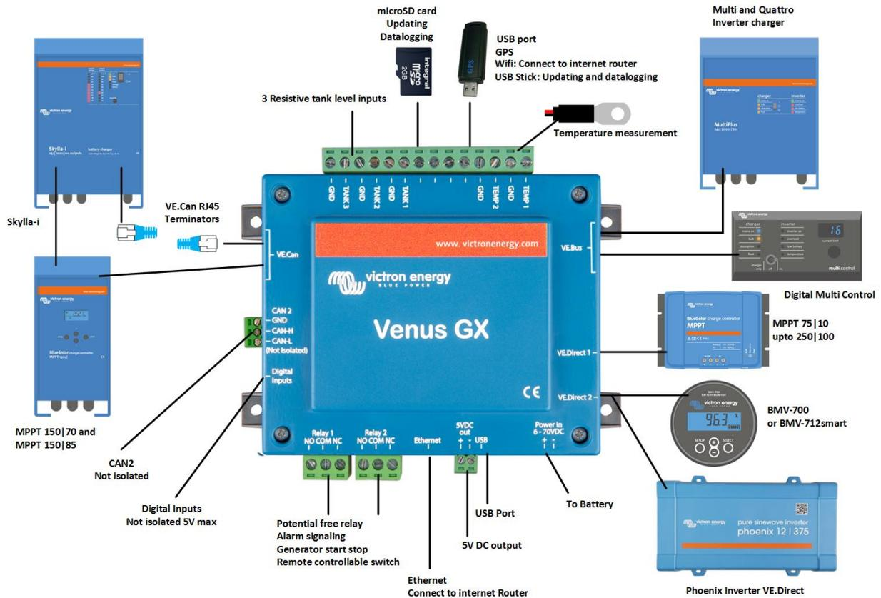
Das Venus GX unterstützt maximal 6 VE.Direct-Geräte, unabhängig davon, ob diese über VE.Direct-Anschlüsse oder USB angeschlossen sind. Allerdings kann dieser Grenzwert in komplexen Systemen, beispielsweise bei mehreren PV-Wechselrichtern oder synchronisierten Wechselrichtern, niedriger sein. Bitte lassen Sie bei der Systemkonzeption stets etwas Spielraum, um einen zuverlässigen Betrieb zu gewährleisten.
