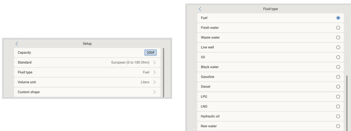
Dies geschieht im Einrichtungsmenü des Tanksensors in der Remote Console - Geräteliste → [Ihr\_Tanksensor] → Einrichtung → Flüssigkeitstyp
