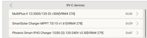
Wenn Sie das Untermenü eines RV-C-Geräts aufrufen, sehen Sie allgemeine RV-C-Geräteinformationen und vor allem das Konfigurationsmenü, wenn Sie bis zum Ende der Seite nach unten scrollen. Die Anzeige des Konfigurationsmenüs erfordert mindestens eine Zugangsebene für Benutzer und Installateure, siehe Kapitel [Menüstruktur und konfigurierbare Parameter \[67\]](#).
