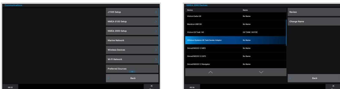
4. Konfigurieren Sie die Tankfüllstandssensoren, indem Sie einen Bildschirm mit Messgeräten öffnen und dann Menü > Tankvoreinstellung wählen. Dort können Sie einen Tankfüllstandssensor zur Konfiguration auswählen sowie den Namen, den Typ, den Stil, die Kapazität und die Position des Tanks ändern.
