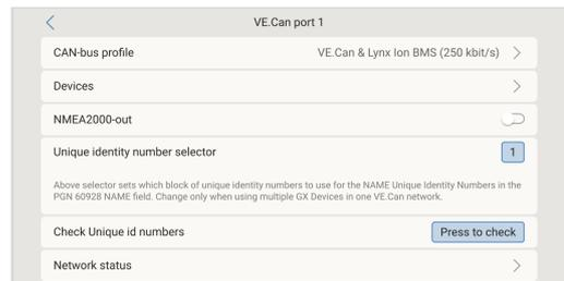
Wenn alle Verkabelungen abgeschlossen sind und die Einrichtung korrekt durchgeführt wurde, wird der Fischer-Panda-Generator in der Geräteliste angezeigt:
