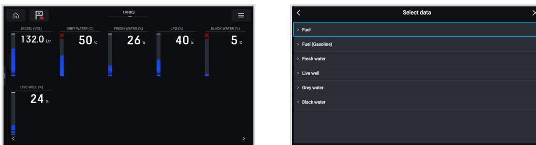
Durch langes Tippen auf einen der Tanks können Sie weitere Konfigurationen vornehmen, z. B. den anzuzeigenden Tank auswählen oder, falls verfügbar, die Einheit von Prozent auf Volumen ändern.
