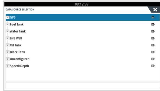
4. Die Auswahl eines Tanksensors aus dem Menü zur Auswahl der Datenquelle zeigt zusätzliche Details und Konfigurationsoptionen an, wie z. B. den Flüssigkeitstyp, den Standort oder den benutzerdefinierten Namen. Anschließend öffnen Sie ein Dashboard oder erstellen ein benutzerdefiniertes Dashboard und platzieren die Tanksensoren wie gewünscht.
