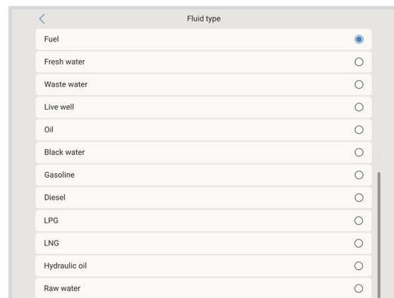
Dies geschieht im Einrichtungsmenü des Tanksensors in der Remote Console - Geräteliste → [Ihr\_Tanksensor] → Einrichtung → Flüssigkeitstyp
