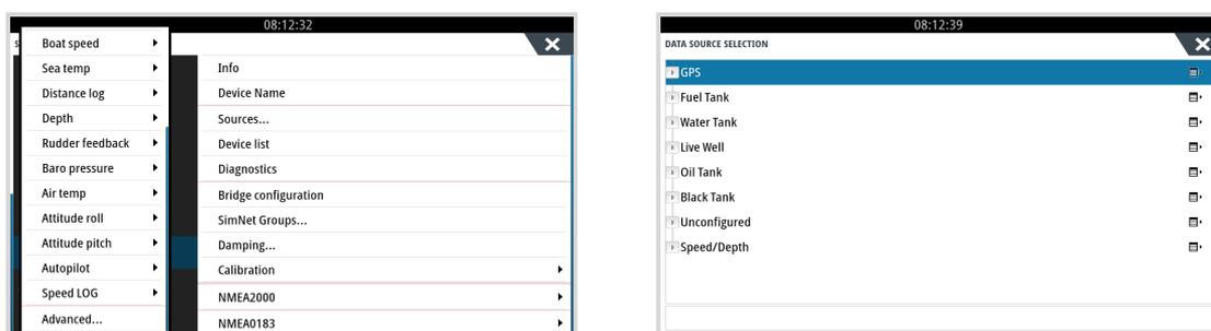
4. Die Auswahl eines Tanksensors aus dem Menü zur Auswahl der Datenquelle zeigt zusätzliche Details und Konfigurationsoptionen an, wie z. B. den Flüssigkeitstyp, den Standort oder den benutzerdefinierten Namen. Anschließend öffnen Sie ein Dashboard oder erstellen ein benutzerdefiniertes Dashboard und platzieren die Tanksensoren wie gewünscht.
