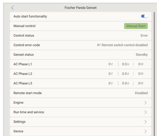
Die Motortemperatur, die Drehzahl und weitere Informationen sind über den Untermenüpunkt Motor verfügbar.
