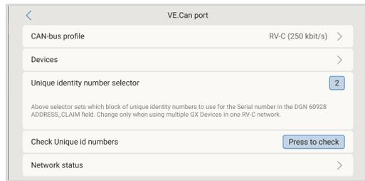
Das Untermenü Geräte enthält alle Geräte des RV-C-Netzwerks einschließlich der RV-C-Ausgangsgeräte. Letztere werden durch ihre [VRM#-Instanz] identifiziert, über die sich die „echten“ Geräte aus dem Stammmenü des GX-Geräts ermitteln lassen. Die Hexadezimalzahl auf der rechten Seite ist die Quelladresse.
