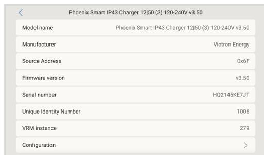
Die Instanz für die entsprechenden DGNs kann im Untermenü Konfiguration geändert werden.
