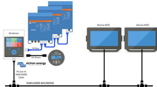
Die GX-Geräte von Victron Energy verfügen über eine NMEA 2000-Ausgangsfunktion: Wenn sie aktiviert ist, fungiert das GX-Gerät als Brücke: Es macht alle Batteriemonitore, Wechselrichter/Ladegeräte und andere Produkte, die an jedes GX-Gerät angeschlossen sind, im NMEA 2000-Netzwerk verfügbar.
