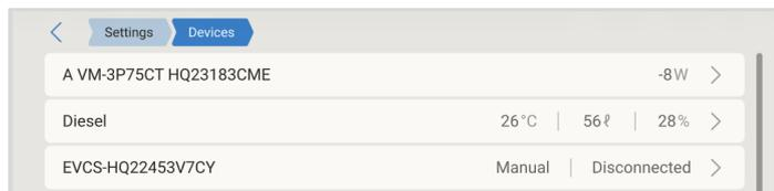
Die Steuerung der EVCS ist auch über das Bedienfeld möglich, indem Sie auf die Schaltfläche
