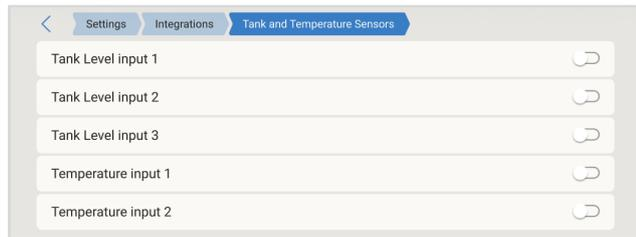
2. Geben Sie unter Einstellungen → Geräte → Tankeingang → Gerät → Name jedem Tankeingang einen eindeutigen Namen, z. B. Frischwasser 1, Grauwasser SB, Dieselanschluss usw.
