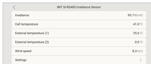
Im Untermenü „Einstellungen“ können Sie alle optionalen oder zusätzlichen externen Sensoren, die an den Strahlungssensor der Serie IMT Si-RS485 angeschlossen sind, manuell aktivieren oder deaktivieren.
