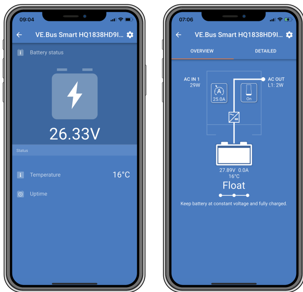
Schermate VictronConnect senza e con inverter/caricabatteria collegati.
