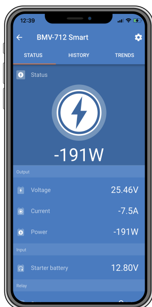
VictronConnect-app-statusschem van een accubewaker die in de DC-bewakingmodus draait.
