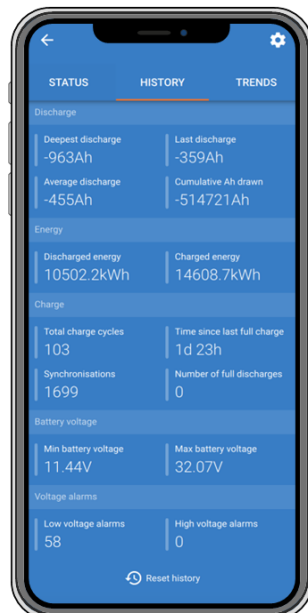
Appen VictronConnect historikskärm för batteriövervakning.
