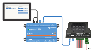
SmartSwitch DC4 ansluten sist i VE.Can-nätverket
