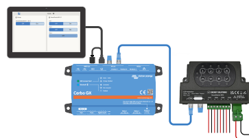
SmartSwitch DC4 conectado en el extremo de la red VE.Can
