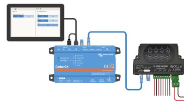
SmartSwitch DC4 am Ende des VE.Can-Netzwerks angeschlossen
