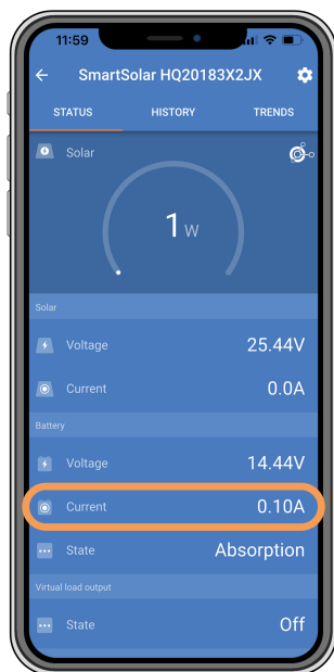
De VictronConnect-app toont een laadstroom van dichtbij nul.
