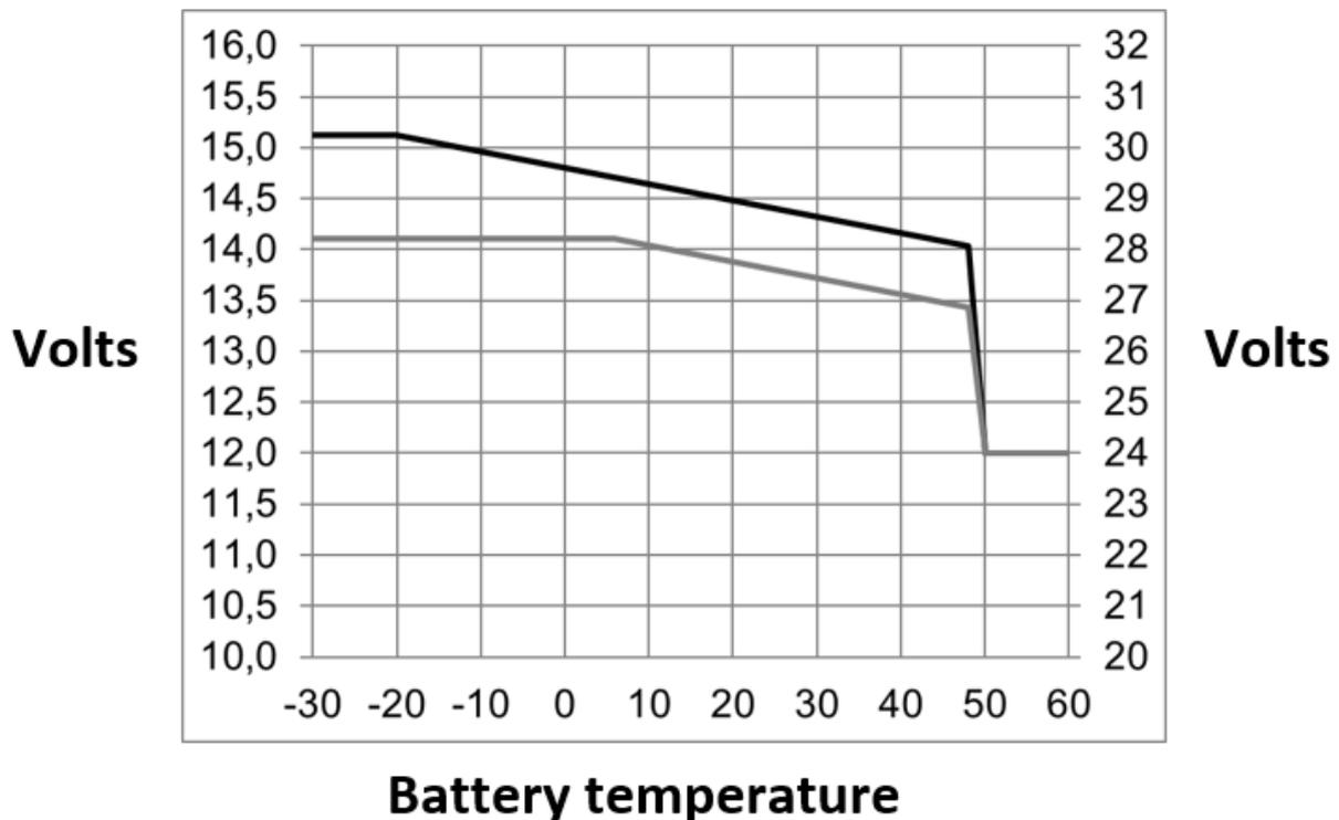
Die standardmäßigen Ausgangsspannungen für den Ladeerhaltungs- und Konstantspannungsmodus gelten bei 25 °C.
