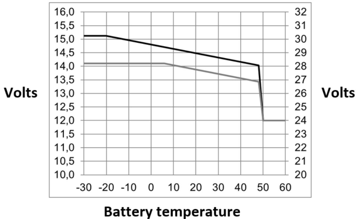
O gráfico anterior mostra as tensões de saída padrão em Flutuação e Absorção a 25 °C para bancos de baterias de 12 V e 24 V. Num banco de baterias de 48 V, multiplique as tensões de 24 V por 2.
