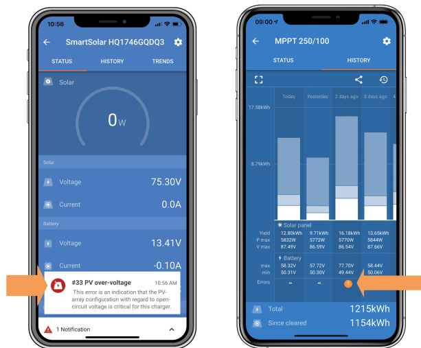
Indication d'erreur #33 de l'application VictronConnect sur l'écran d'état et l'écran d'historique.
