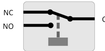
Funcionamento interno do relé programável
