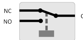
Configuración del relé (sin corriente)
