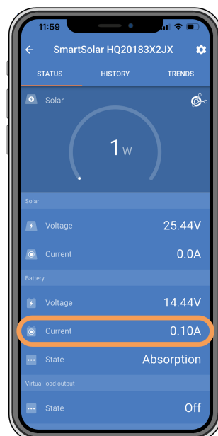
La aplicación VictronConnect muestra una corriente de carga cercana a cero.
