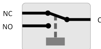
Interner Betrieb des programmierbaren Relais
