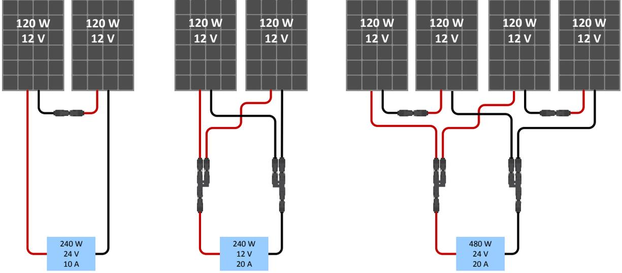
Seri, paralel ve seri/paralel güneş panellerinin örnekleri.
