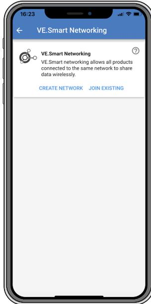
VE.Smart Networking, aynı ağa bağlı çeşitli ürünlerin Bluetooth üzerinden veri paylaşmasını sağlar. VE.Smart Networking, özellikle GX cihazının kurulu olmadığı daha küçük sistemler için tasarlanmıştır.
