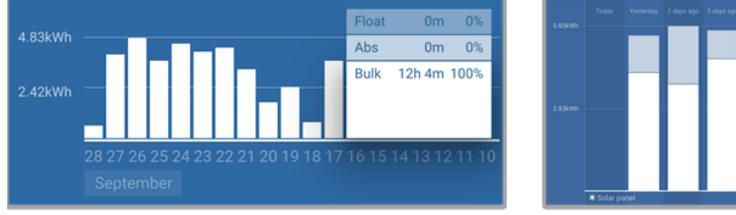
Sol: Tüm vaktini bulk aşamasında geçiren bir sistem örneği. Sağ: Şarj aşamalarının dökmü - Sistem, bulk ve absorpşon aşamalarında süre geçiriyor.
