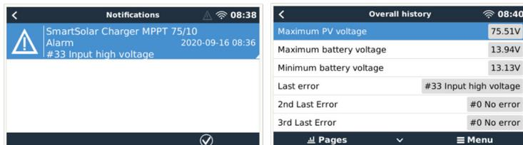
Alarm bildirimini ve geçmiş hataları gösteren GX cihazı.
