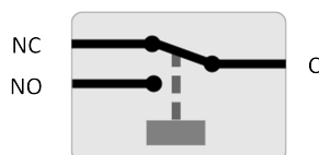
Configurarea releului (fără alimentare).
