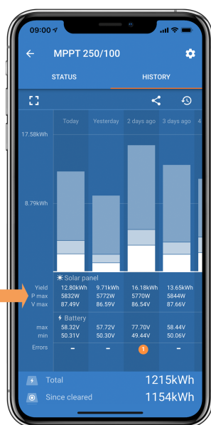
Citire istoric Pmax în aplicația VictronConnect.
