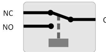
Fonctionnement interne du relais programmable
