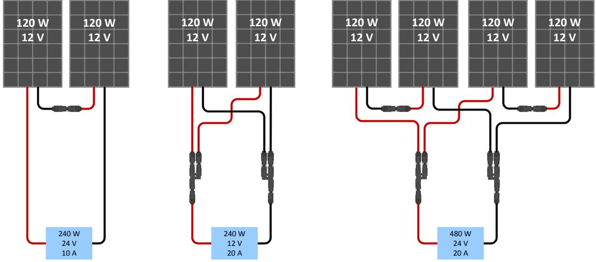
Seri, paralel ve seri/paralel güneş panellerinin örnekleri.
