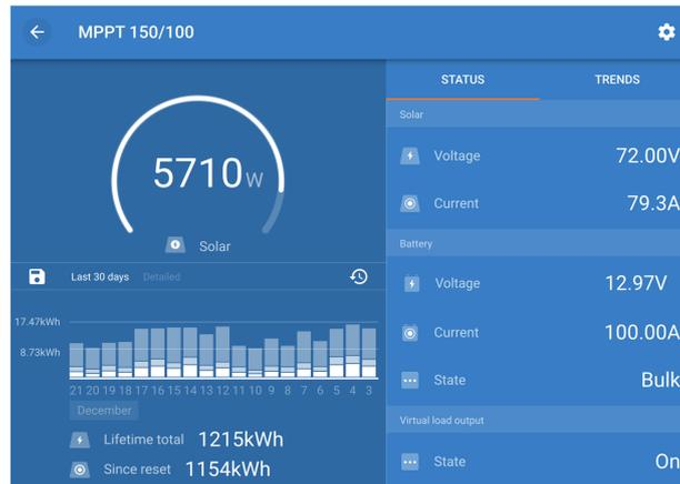
Gerçek zamanlı veriler ile geriye dönük verilerin gösterildiği VictronConnect uygulamasının ekran görüntüsü.
