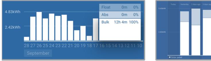
Sol: Tüm vaktini bulk aşamasında geçiren bir sistem örneği. Sağ: Şarj aşamalarının dökümü - Sistem, bulk ve absorption aşamalarında süre geçiriyor.
