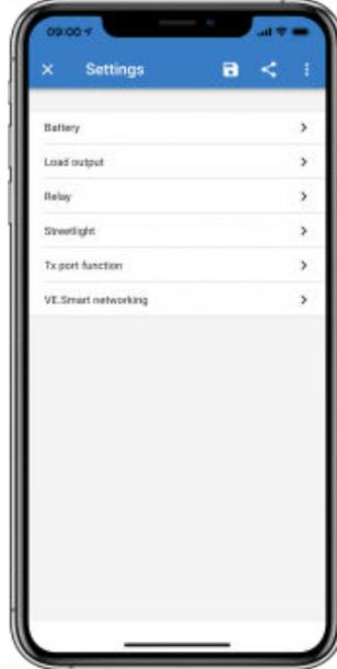
Güneş enerjili şarj cihazı ayarlarına erişmek için ayarlar sayfasına gidin. Ana ekranın sağ üst kısmında bulunan dişli çark
