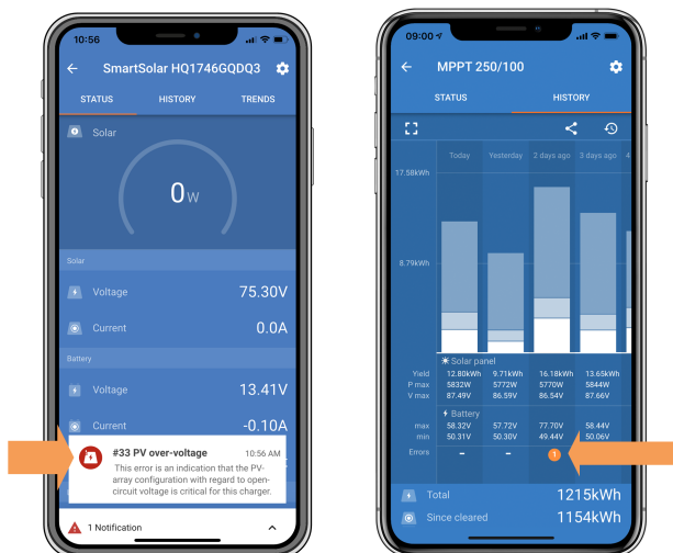
Indicarea erorii 33 din aplicația VictronConnect pe ecranul de stare și pe ecranul de istoric.
