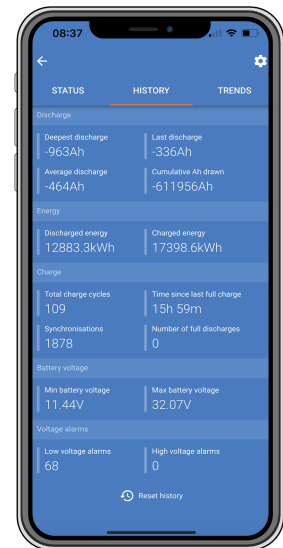
Appen VictronConnect visar batteriövervakningshistorik
