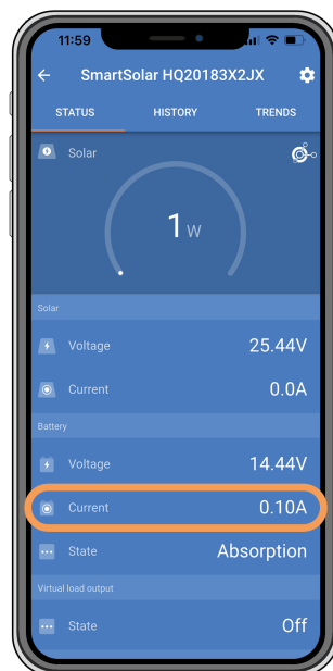
L'application VictronConnect indique un courant de charge proche de zéro.
