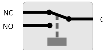
Ohjelmoitavan releen sisäinen toiminta
