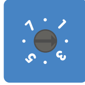
Kiertokytkin asetettu asentoon 2
