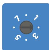
2 konumuna ayarlanmış döner anahtar
