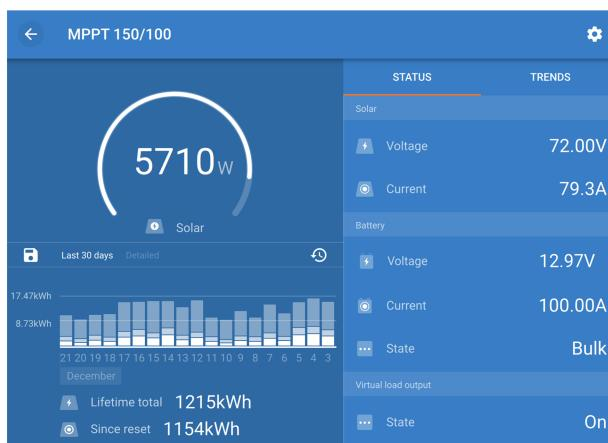
Gerçek zamanlı veriler ile geriye dönük verilerin gösterildiği VictronConnect uygulamasının ekran görüntüsü.
