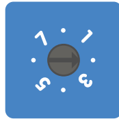
Roterande brytare inställd på position 2
