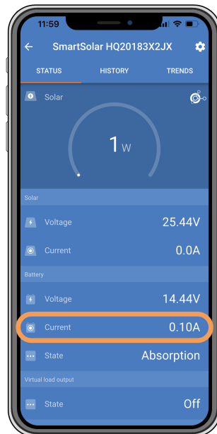
A aplicação VictronConnect apresenta uma corrente de carga próxima de zero.
