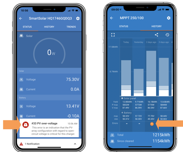
Indicação de erro #33 do aplicação VictronConnect no ecrã de estado e no ecrã de histórico.
