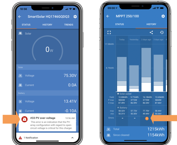
Indicación de error n.º 33 de la aplicación VictronConnect en la pantalla de estado y en la de historial
