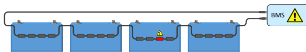
O BMS recebe um sinal de alarme de uma célula numa configuração de bateria múltipla
