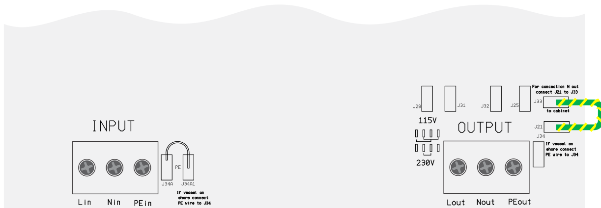
Liaison neutre (N)-terre (PE) de la sortie CA.
