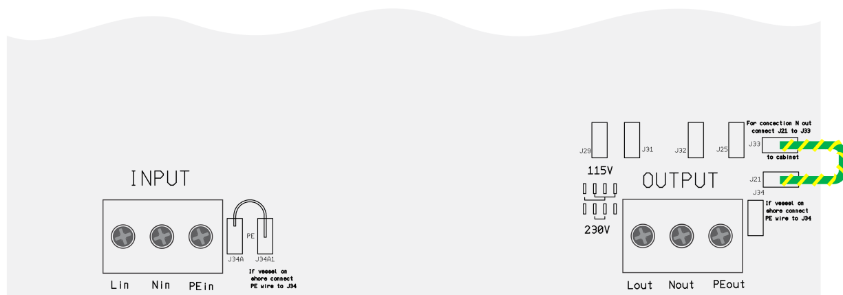
Neutralne wyjście AC (N) do uziemienia (PE).
