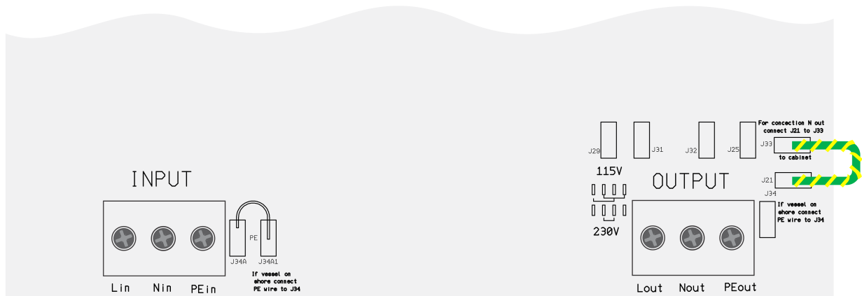
Enlace del neutro de la salida CA (N) a tierra (PE).
