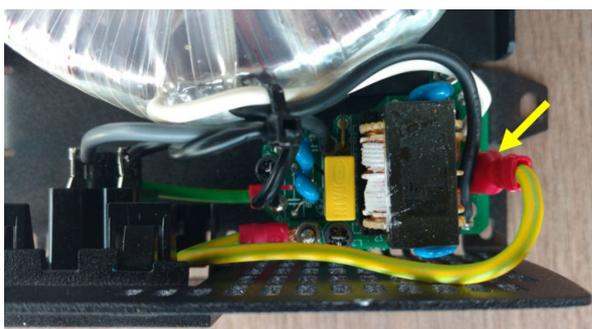
2. Нейтраль, подключенная к защитному заземлению
