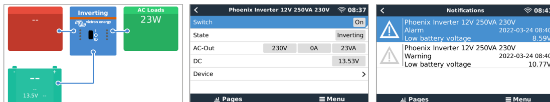
Exemple de ecrane GX de la stânga la dreapta: ecran sistem, ecran dispozitiv inverter și un mesaj de alarmă.
