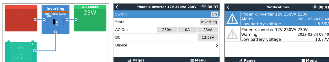
Esempio di schermate del GX, da sinistra a destra: schermata del sistema, schermata del dispositivo dell'inverter e messaggio di allarme.
