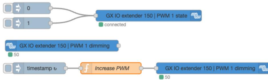
La partie supérieure de ce flux sert à activer ou désactiver le port PWM à l'aide du paramètre d'état PWM. Une fois le port activé, il utilise la valeur PWM définie via le paramètre de gradation PWM. Le nœud d'entrée lit la valeur actuelle du port PWM et la stocke dans le contexte global Node-RED.
