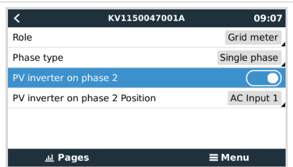
Einphasig mit Doppelfunktion zur Messung des Netzes auf L1 und eines PV-Wechselrichters auf L2
