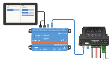
SmartSwitch DC4 ansluten sist i VE.Can-nätverket
