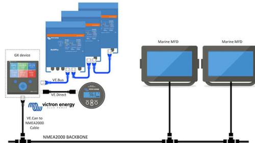
Les dispositifs GX de Victron Energy disposent d'une fonction de sortie NMEA 2000. Lorsqu'elle est activée, le dispositif GX fait office de pont : il rend tous les contrôleurs de batterie, convertisseurs/chargeurs et autres produits connectés au dispositif GX disponibles sur le réseau NMEA 2000.
