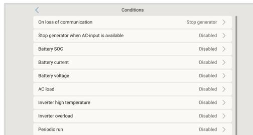
**Les paramètres suivants peuvent être définis par l'utilisateur pour déclencher un démarrage/arrêt automatique du générateur :**
