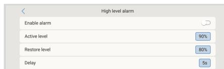
Les données de niveau de réservoir sont envoyées au [portail VRM](#) et peuvent être surveillées à distance. Elles peuvent aussi déclencher un relais s'il est configuré sur « Pompe du réservoir ». Les niveaux peuvent aussi être affichés ailleurs dans l'environnement GX :
