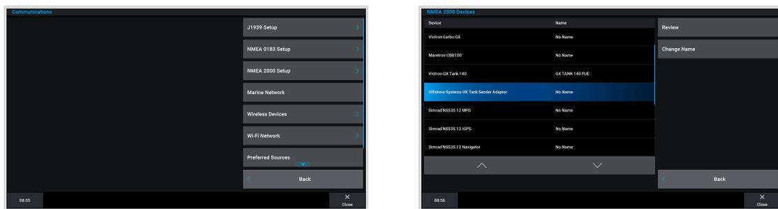
4. Configurez les capteurs de niveau de réservoir en ouvrant un écran de jauges, puis en sélectionnant Menu > Préréglage de réservoir où vous pourrez sélectionner un capteur de niveau de réservoir à configurer, modifier le nom, le type, le style, la capacité et la position du réservoir.
