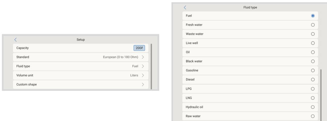
Cette opération s'effectue dans le menu de configuration du capteur de réservoir dans la console à distance - Liste des appareils → [votre\_capteur\_de\_réservoir] → Configuration → Type de liquide.
