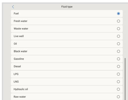
Cette opération s'effectue dans le menu de configuration du capteur de réservoir dans la console à distance - Liste des appareils → [votre\_capteur\_de\_réservoir] → Configuration → Type de liquide.
