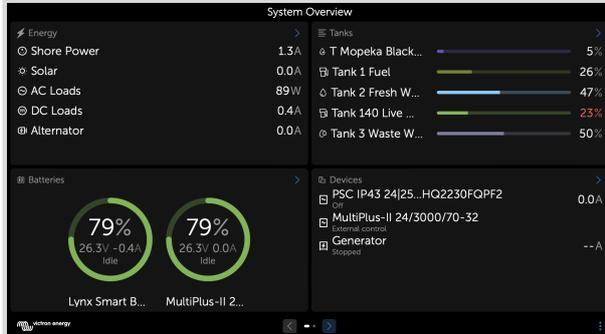
Un Glass Bridge est un MFD (écran multifonction) qui intègre les systèmes et l'état de navigation d'un bateau sur un grand écran ou plusieurs écrans à la barre du bateau, éliminant ainsi les problèmes causés par la multiplication des jauges, des supports et des câblages.
