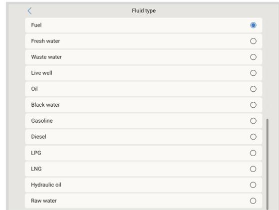
Cette opération s'effectue dans le menu de configuration du capteur de réservoir dans la console à distance - Liste des appareils → [votre\_capteur\_de\_réservoir] → Configuration → Type de liquide.
