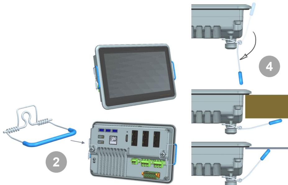
Si l'Ekrano GX n'est pas accessible par l'arrière, il peut être monté par l'avant.
