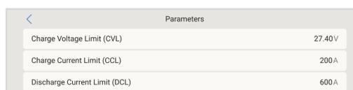
Lorsqu'il fonctionne en mode conversion (c'est-à-dire en mode îlot), le Multi ou le Quattro s'éteint si le courant de décharge maximal est réglé sur zéro. Il redémarre automatiquement soit lorsque le réseau CA est rétabli, soit lorsque le BMS augmente le courant de décharge maximal.
