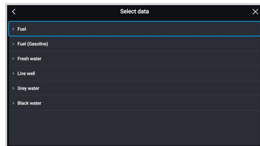
En appuyant longuement sur l'un des réservoirs, vous pouvez effectuer d'autres réglages, par exemple sélectionner le réservoir à afficher ou, le cas échéant, changer l'unité de pourcentage en unité de volume.
