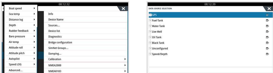
4. La sélection d'un capteur de réservoir dans le menu de sélection de la source de données permet d'obtenir des détails supplémentaires et des options de configuration telles que le type de liquide, l'emplacement ou la personnalisation du nom. Enfin, ouvrez un tableau de bord ou créez un tableau de bord personnalisé et disposez les capteurs de réservoir comme vous le souhaitez.
