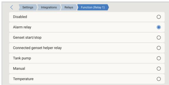
Par défaut, le relais est défini sur normalement ouvert (NO). La polarité peut être inversée en normalement fermé (NC). Remarque : l'inversion vers NC entraîne une consommation légèrement plus élevée de du dispositif GX.
