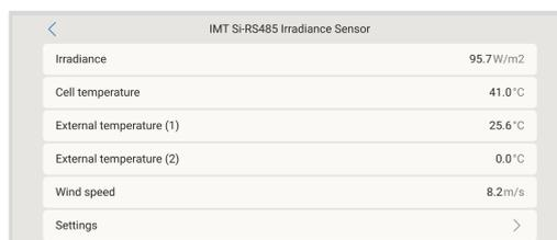
Dans le sous-menu « Paramètres », vous pouvez activer ou désactiver manuellement tout capteur externe optionnel ou additionnel connecté au capteur d'irradiance solaire IMT de la série Si-RS485.
