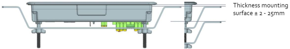
Montez l'Ekrano GX par l'arrière lorsqu'il est facilement accessible.
