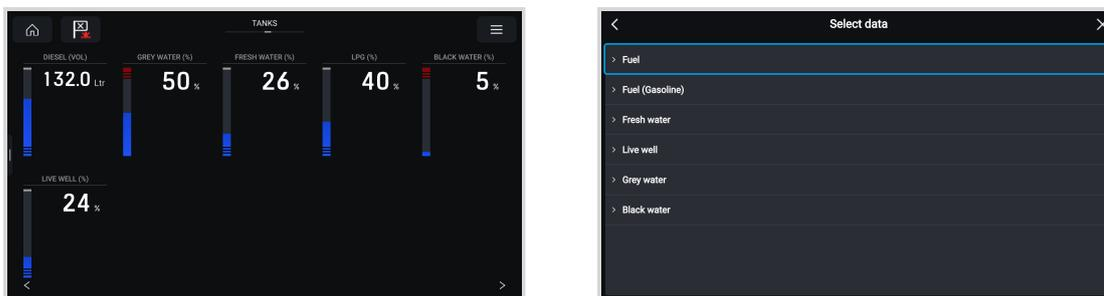
En appuyant longuement sur l'un des réservoirs, vous pouvez effectuer d'autres réglages, par exemple sélectionner le réservoir à afficher ou, le cas échéant, changer l'unité de pourcentage en unité de volume.
