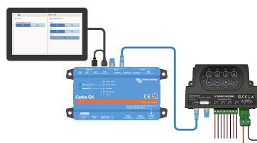
SmartSwitch DC4 aangesloten op het einde van het VE.Can netwerk
