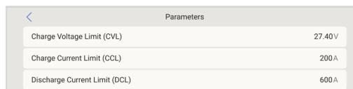
Ao efetuar a inversão (ou seja, no modo de ilhamento), os Multi e Quattro desligam-se quando a corrente de descarga máxima estiver definida como zero. Começam a funcionar automaticamente quando a rede elétrica CA for reposta ou o BMS aumentar a corrente de descarga máxima.
