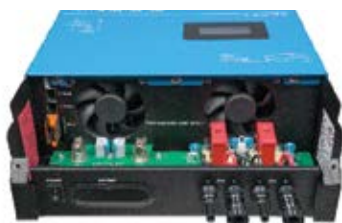
À l'intérieur du SmartSolar MPPT RS 450|100
