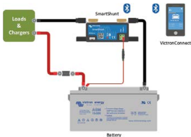
Câblage de base du SmartShunt
