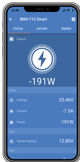
Ecranul de stare VictronConnect al unui monitor de baterie care funcționează în modul de monitorizare CC.
