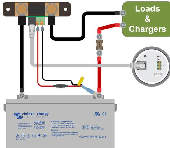
Monitor della batteria con rilevamento ausiliario della temperatura.
