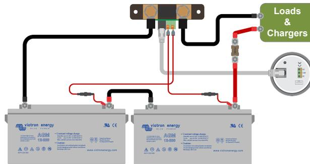
Monitor della batteria con monitoraggio ausiliario del punto medio.
