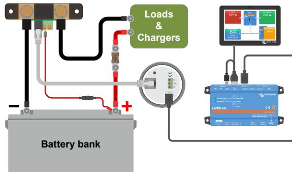
Il monitor della batteria è collegato a un Cerbo GX e a uno schermo GX Touch.
