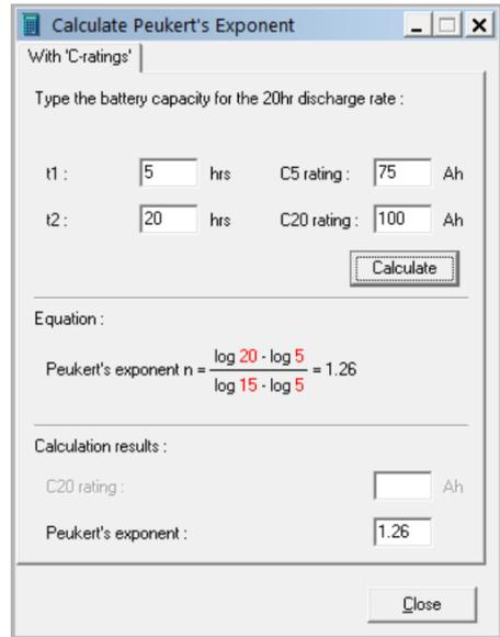
Tenere presente che il coefficiente di Peukert è non altro che una grossolana approssimazione alla realtà e che, con correnti molto alte, le batterie forniranno ancor meno capacità di quella prevista da un coefficiente fisso. Sconsigliamo di cambiare il valore predefinito nel monitor della batteria, tranne nel caso delle batterie al litio.
