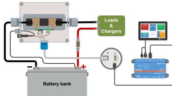
*Le contrôleur de batterie est connecté à un [Cerbo GX](#) et à un écran [GX Touch](#).*
