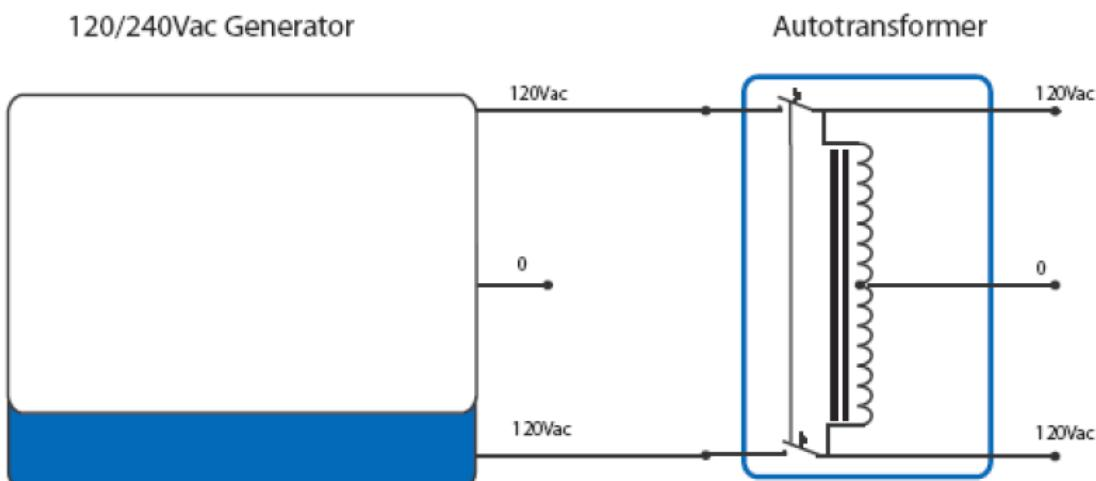
Com um AT, a energia de uma secção pode ser "transferida" para a outra secção, o que cria um nível de carga total muito superior, desbloqueando todo o potencial de potência disponível de um gerador ou inversores empilhados.
